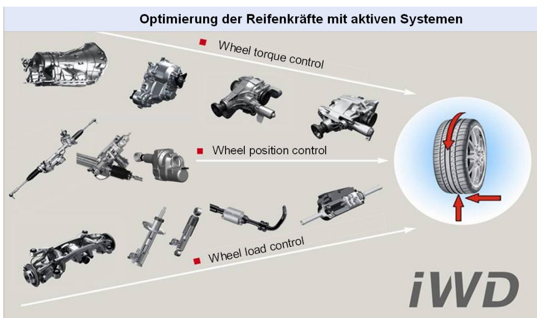
Fig. 10: AKC ® im Systemverbund von Antriebsstrang und Fahrwerk
